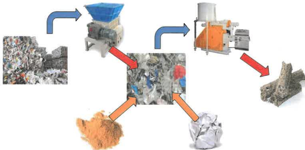
Obrázok 7: Schematická ilustrácia spracovania komunálneho odpadu
