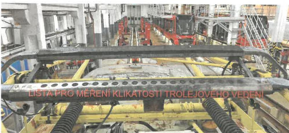
Obr. 1: Lišta pro měření klikatosti trolejového vedení. Zdroj: Vlastní.
