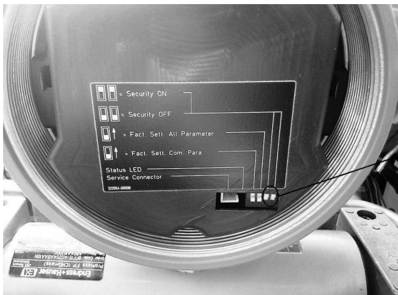
Obr. č. 4 Umiestnenie prepínačov v elektronike meradla
