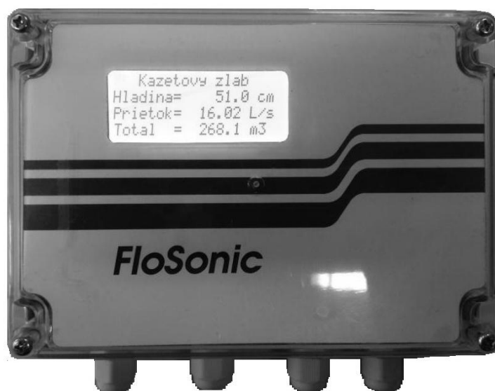
Obr. č.2 Elektronická vyhodnocovacia jednotka FloSonic
