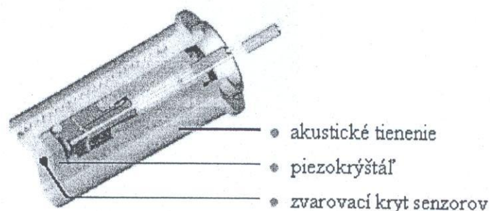
Obr. č. 8 - Konštrukčná schéma snímača s hermeticky utesnenými senzormi
