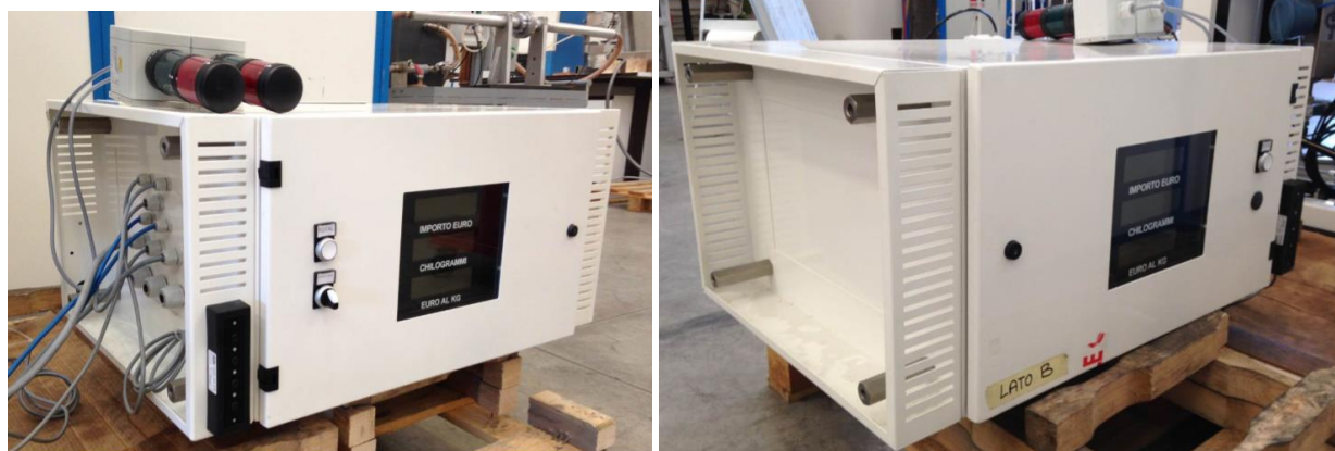
Obr. č. 3 Vonkajší vzhľad elektronického počítadla výdajného stojana
