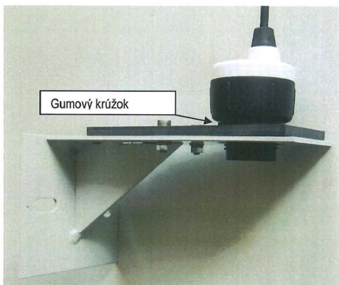
Obr. č. 4 Držiak so senzorom výšky hladiny EchoPod
