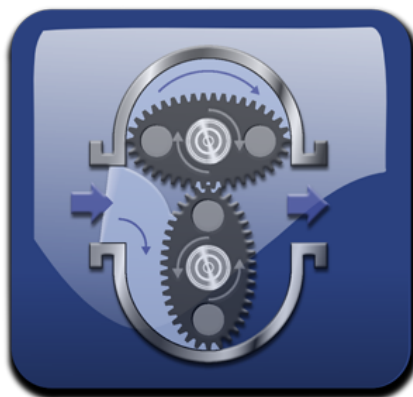
Obr. č. 2 – Merací princíp objemového prietokového meradla
