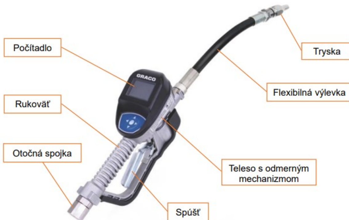
Obr. č. 3 – Merací dávkovací ventil Pulse® s flexibilnou výlevkou
