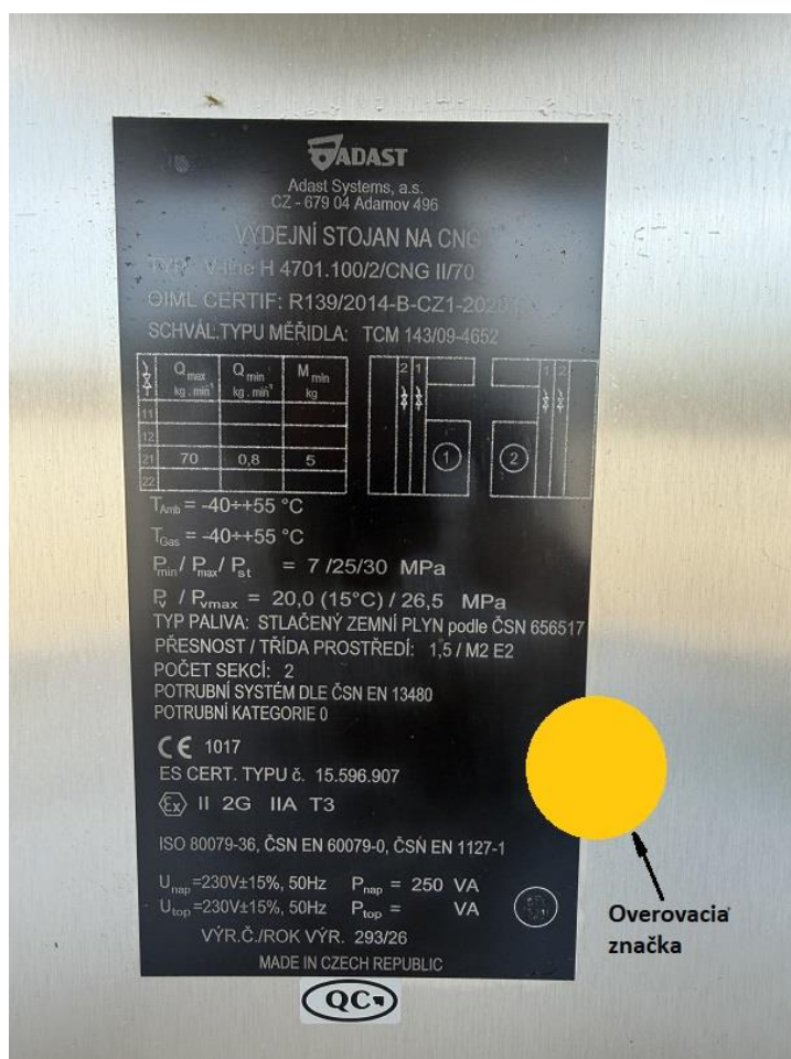
Obr. 6 Příklad umístění overovacej značky na hlavní štítok výdajného stojanu typu ADAST V-line 47xx.xxx/CNG
