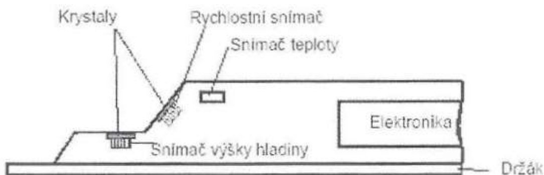
Obr. č. 3 Konštrukcia kombinovaného snímača POA-VIH1KT
