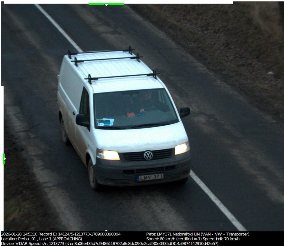
Snímka zo vstupu do meracieho úseku
