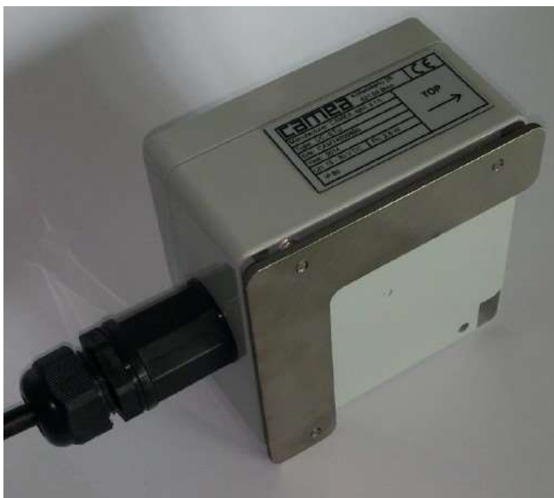
Obr. G : Prijímač satelitného času UC-STU
