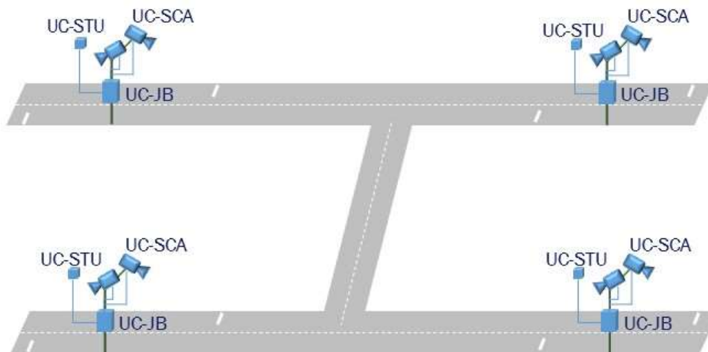
Obr. K : Príklad kaskádového usporiadania
