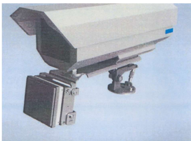
Obr. 8: Držiak kamery s radarovým senzorom mechanicky zabraňujúci zámene kamier a senzora. Modro označené miesto je pre zabezpečovaciu značku výrobcu.
