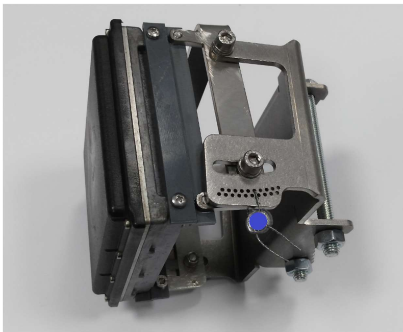
Obr. 11: Radarový senzor s neoddeliteľným držiakom. Modro vyznačené sú miesta pre plombovacie značky výrobcu.
