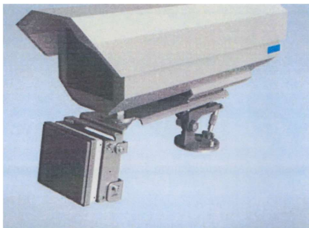
Obr. 2: Držiak kamery s radarovým senzorom mechanicky zabraňujúci zámene kamier a senzora. Modro označené miesto je pre zabezpečovaciu značku výrobcu.
