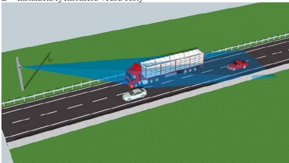
C – Dôležité parametre pri inštalácii cestného rýchlomera
