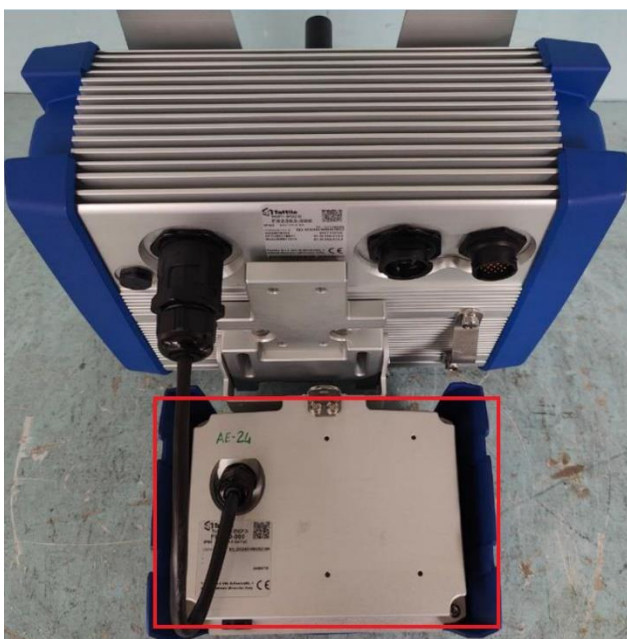
Značka overenia plní funkciu i zabezpečovacej značky a umiestni sa na zadnú stranu modulu s radarovou hlavou (červený štvorec).
