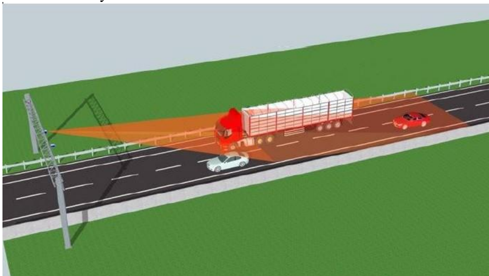
A – Inštalácia rýchlomera kolmo na cestu
