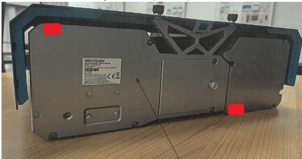
Obr. B : Umiestnenie zabezpečovacích značiek na zadnej strane rýchlomera
