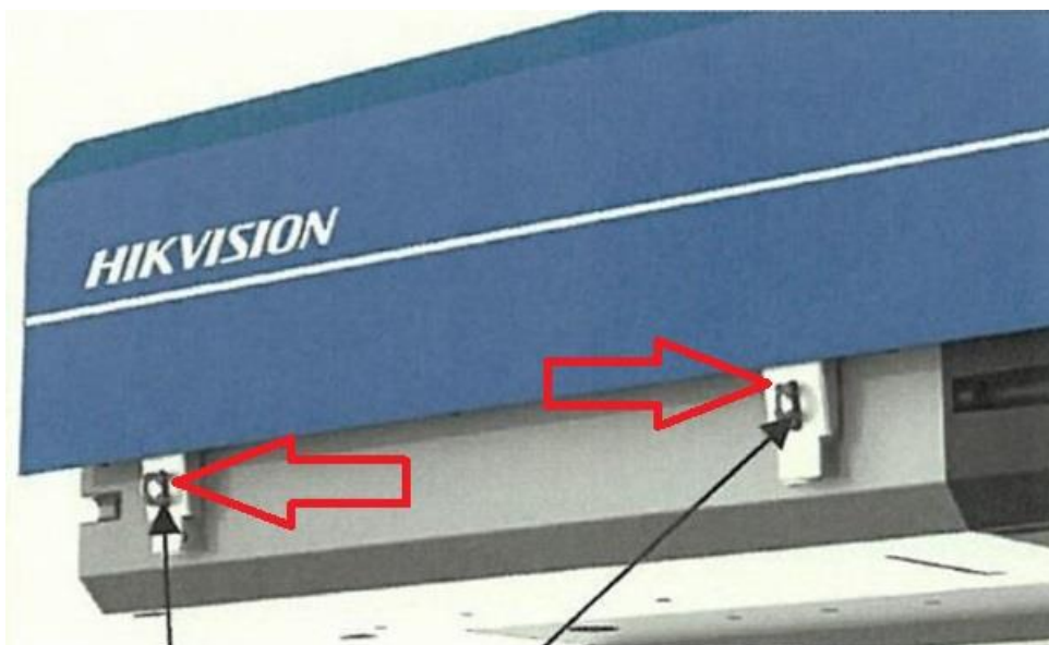
Obr. A : Umiestnenie plomb na vyznačených miestach
