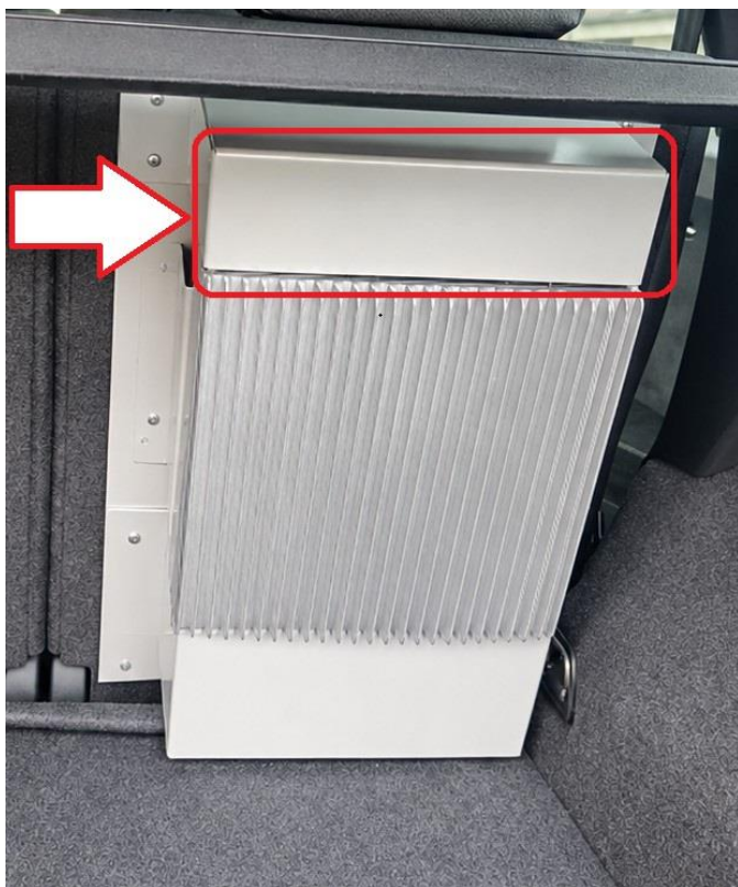
Obr. 4A2 : Umiestnenie overovacej značky na prednej časti krytu riadiaceho počítača – overovacia značka sa umiestni na ploche vyznačenej červeným rámčekom.
