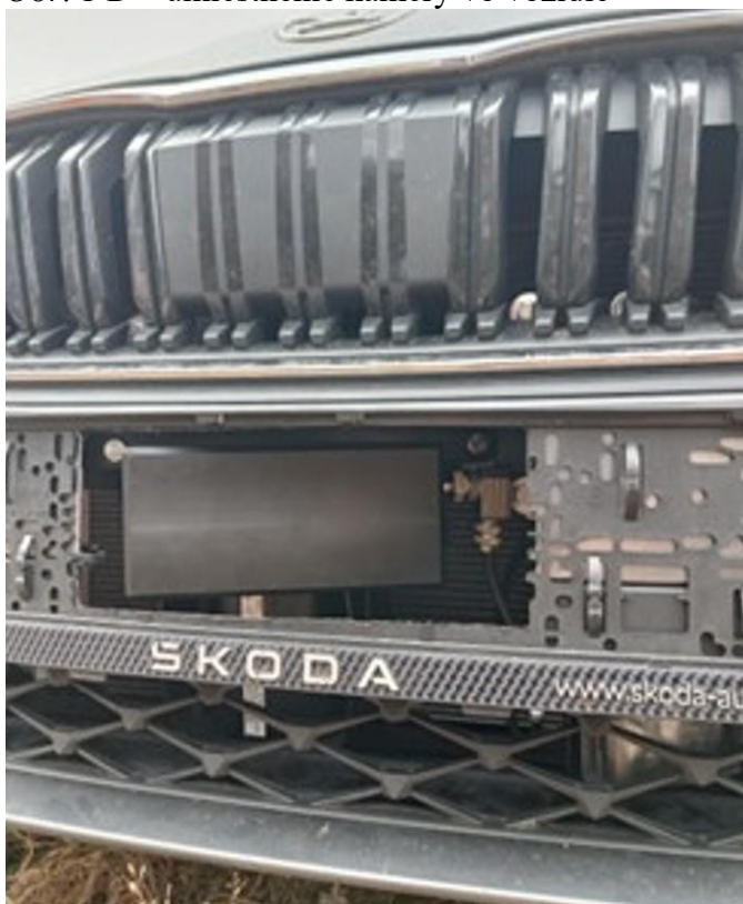
Obr. 1 C – umiestnenie radarovej hlavy na vozidle
