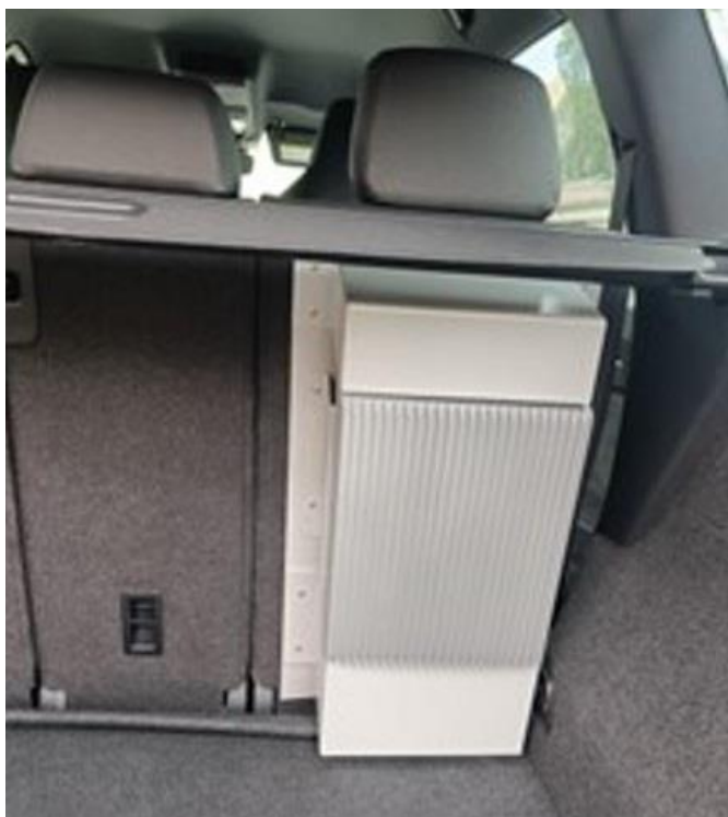
Obr. 1 A – montáž riadiaceho počítača vo vozidle
