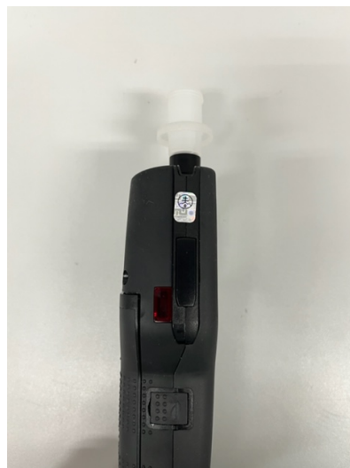
Obrázok č. 4 a č. 5 Umiestenie zabezpečovacej značky na pravej alebo ľavej strane analyzátora.
