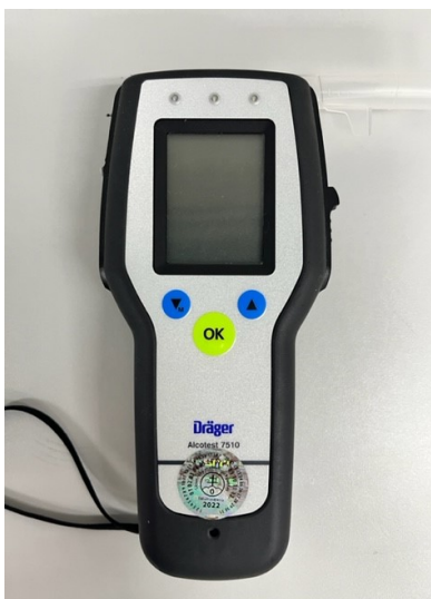
Obrázok č. 3 Overovacia značka umiestená na prednej strane analyzátora.
