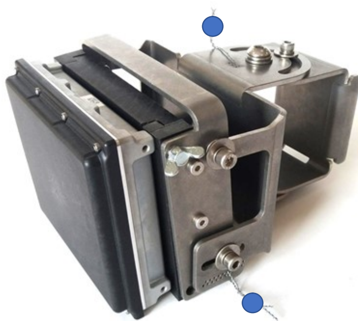
Obr. 10 Umiestnenie overovacích značiek na montážnom oddeľovacom držiaku radarovej jednotky
