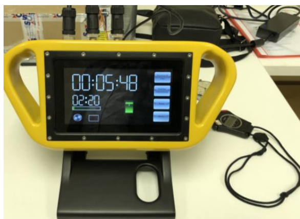
Obrázok č. 4: Zariadenie na kalibráciu stopiek priamou metódou
