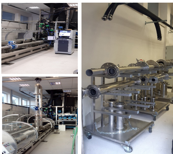
Obrázok 4 Skúšobné metrologické zariadenie PT150, skúška pri vertikálnej polohe montáže meradla, príslušenstvo
