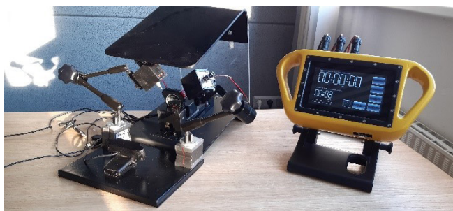
Obrázok 6 Merací systém na kalibráciu plavákových hladinomerov (hore) a merací systém na kalibráciu stopiek (dolu)
