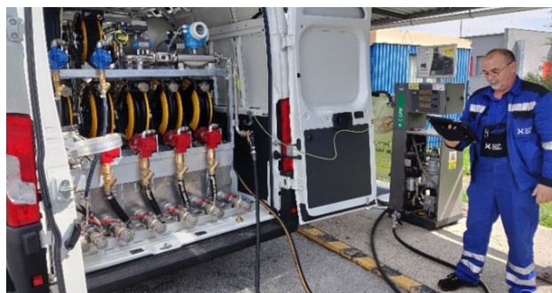
Obrázok č. 23: Inovačné auto na metrologickú kontrolu výdajných stojanov na čerpacích staniciach PHM
